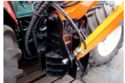
Solide pivot avec grand angle de balayage : 120° vers l'avant (position de transport) et 15° vers l'arrière (sécurité en cas d'obstacle).
