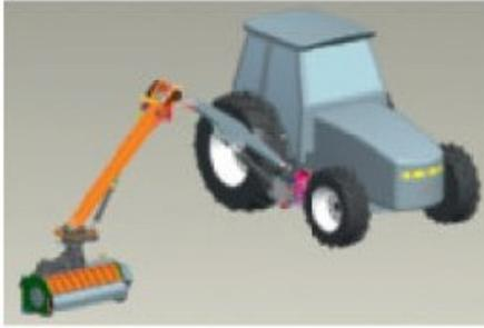
Bras construits dans des profilés d'acier de haute résistance et de grande élasticité pour plus de solidité et de stabilité
