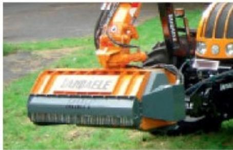
Les PRO sont équipés en standard d'une tête de coupe MMH, orientable à 180°, avec tourelle 185° pour garantir une conduite ergonomique.
