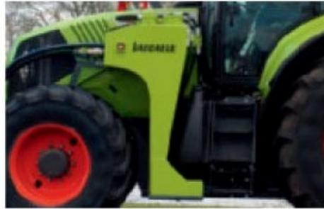
Le réservoir d'huile est construit sur mesure pour garder le maximum d'accessibilité au moteur, au réservoir et à la cabine.
