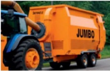
Remorque "Jumbo Max", spécialement conçue pour l'aspiration et le stockage des déchets – 31 m<sup>3</sup> de capacité.
