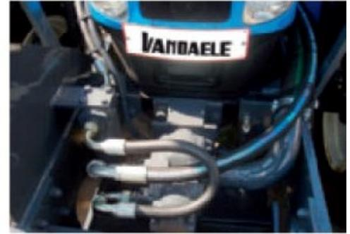
En montage frontal, les pompes sont entraînées par le vilebrequin du moteur. En cas de réservoir arrière, les pompes sont entraînées par la prise de force 540 TPM.
