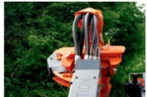
En standard, pivot de 2 x 15° sur le balancier à double fonction : seconde sécurité et articulation complémentaire.
