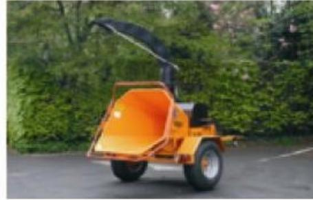
TV180 P ; Version entraînée par tracteur sur châssis pour transport lent (option).
