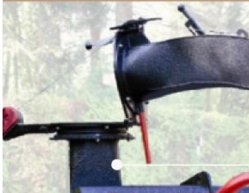
Buse d'éjection inclinable avec treuil (option)
